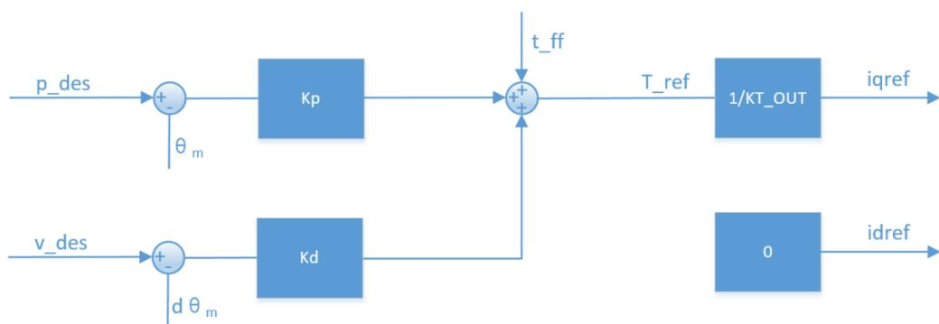
根据 MIT 模式可以衍生出多种控制模式，如  $kp=0, kd \neq 0$  时，给定  $v_{des}$  即可实现匀速转动； $kp=0, kd=0$ ，给定  $t_{ff}$  即可实现给定扭矩输出。
