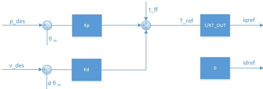
根据 MIT 模式可以衍生出多种控制模式，如  $k_p=0, k_d$  不为 0 时，给定  $v\_des$  即可实现匀速转动； $k_p=0, k_d=0$ ，给定  $t\_ff$  即可实现给定扭矩输出。
